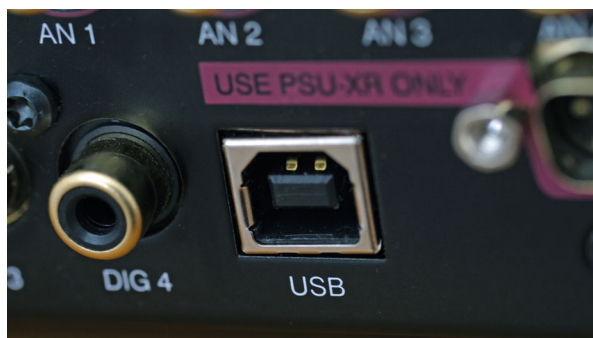
Die USB-B-Schnittstelle für die Audiodatenübertragung vom Rechner/Streamer zum Cyrus i9-XR
