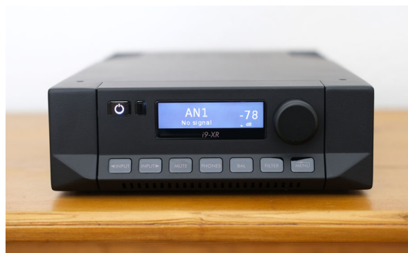
Kompakt, aber hochkonzentriert: Der nur 21,5 Zentimeter breite Cyrus i9-XR hat unter anderem einen DAC sowie ein Phonomodul an Bord.
